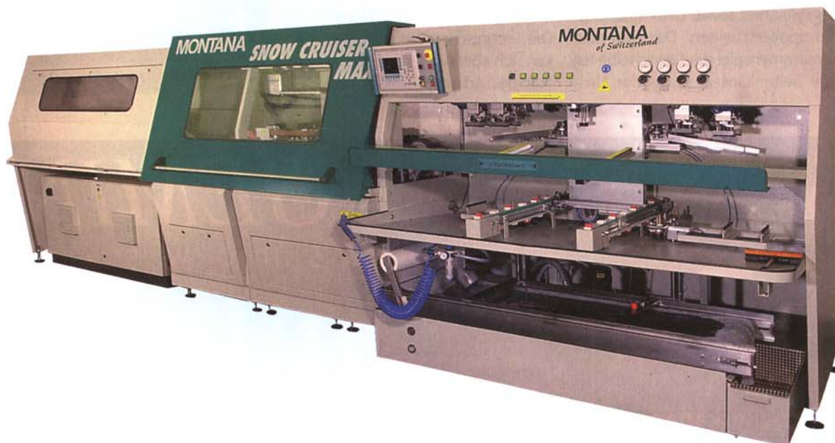
MONTANA SNOW CRUISER, der Roboter zur Komplettbearbeitung von Ski und Snowboard Fotos: MONTANA
